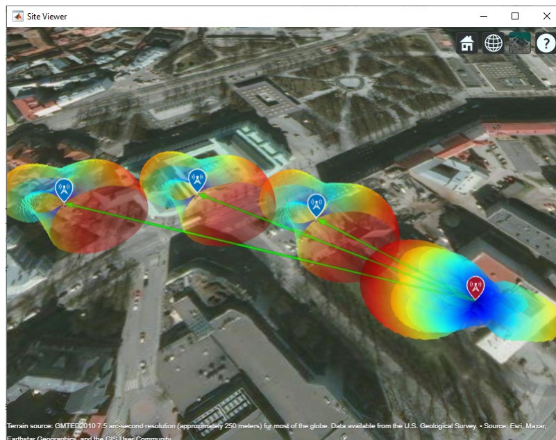
Joonis 8.12. 4G LTE tugijaama 3 ühe sektori ja vastuvõtukohtades kasutatavate antennide suunadiagrammid
