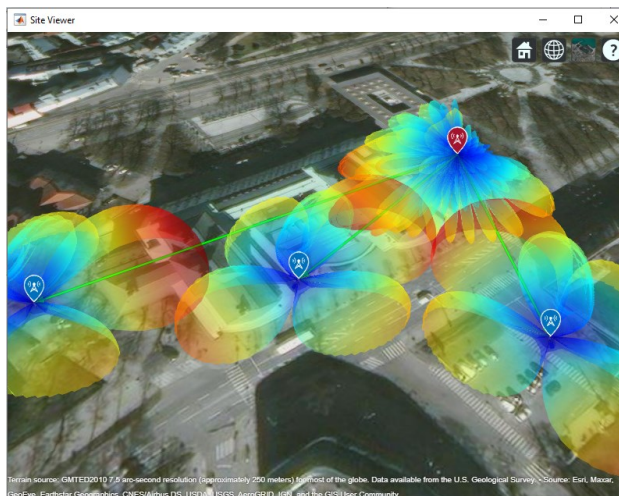
Joonis 8.16. 5G NR tugijaamast 2 ühe sektori ja klientide asukohtades kasutatavate antennide suunadiagrammid (kliendi teenindas on tugijaama antenn suunatud kliendile)
