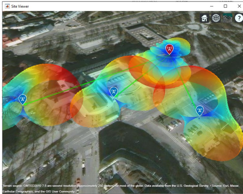
Joonis 8.10. 4G LTE tugijaama 2 ühe sektori ja vastuvõtukohtades kasutatavate antennide suunadiagrammid
