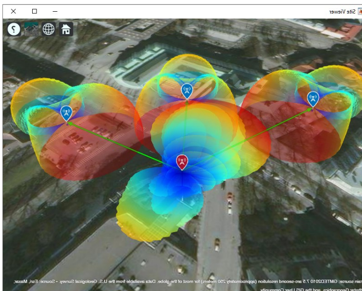
Joonis 8.8. 4G LTE tugijaama ühe sektori ja vastuvõtukohtades kasutatavate antennide suunadiagrammid
